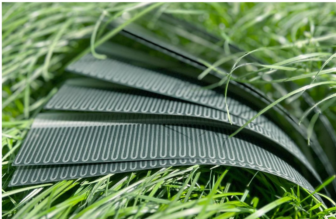
柔性钙钛矿 / CIGS 叠层太阳电池的示意图
