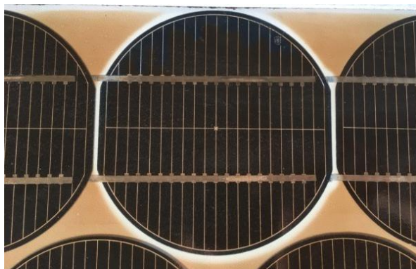
图 2 直径为 102mm 的单晶电池片
